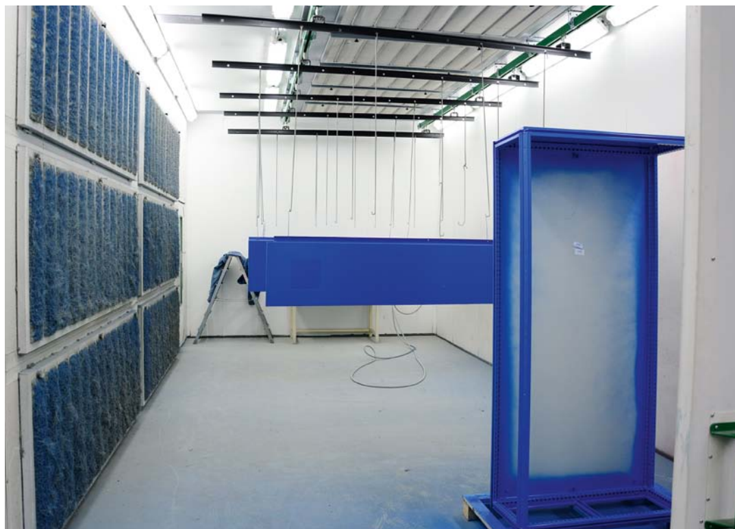
Zur leichteren Pflege ist die Kabine mit Abziehlacken ausgestattet - weiß an den Wänden, mit Klarlack im Bereich der Fenster und mit einem leitfähigen Grauton auf dem Boden. Quelle (zwei Bilder): Redaktion
